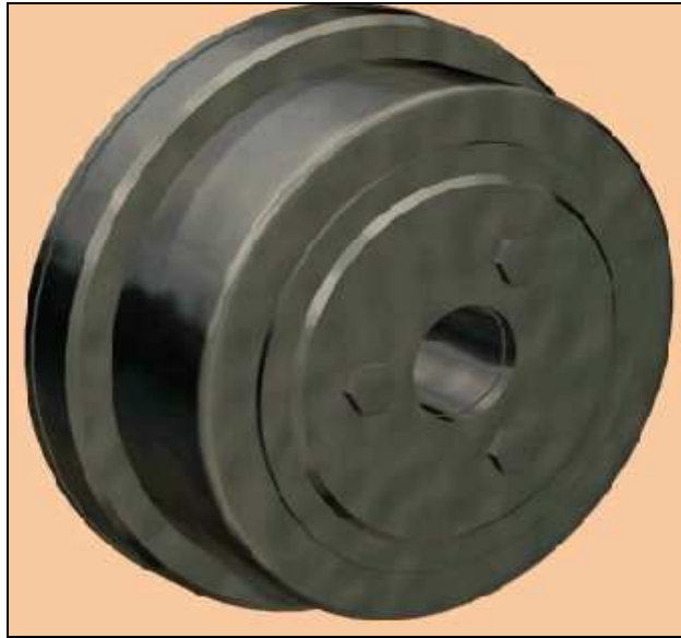
Рисунок 1.5 – Фрикционная муфта сцепления
