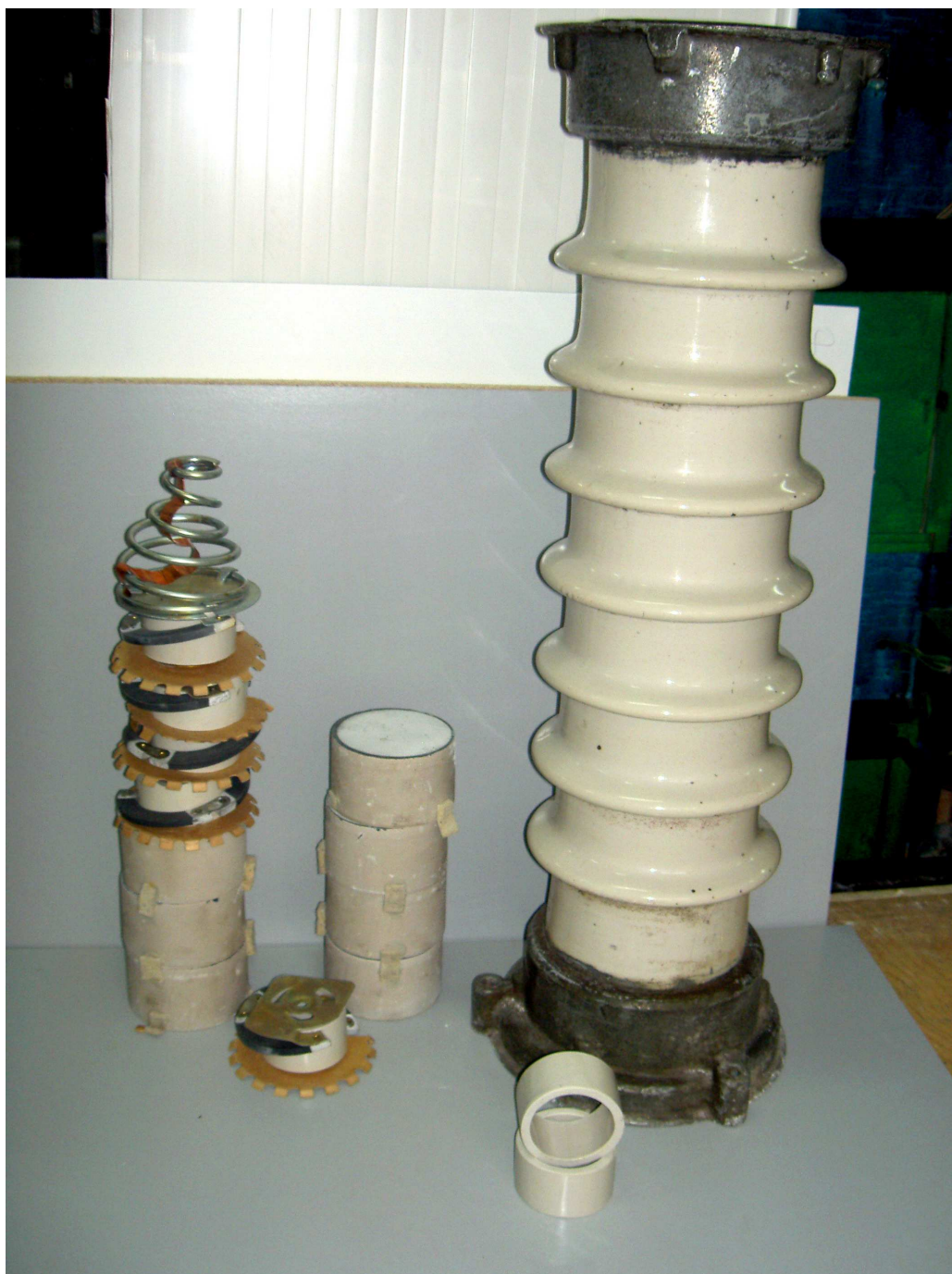
Рисунок 2 - Разрядник РВЭ-25М (разобран)
